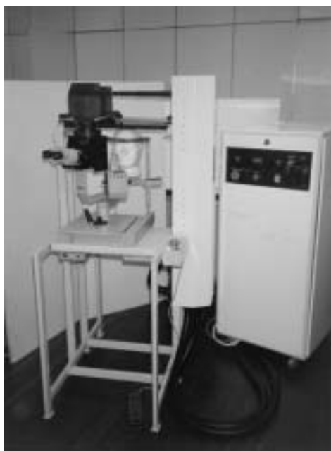
Obr. 18: Fotografie vysokovýkonového impulsního Nd:YAG laseru OFTALAS vyvinutého na ČVUT FJFI a používaného v oční mikrochirurgii
